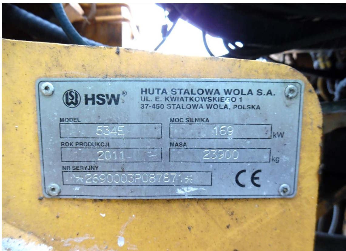
3. Tabliczka znamionowa kompaktora odpadów HSW 534E-LA
