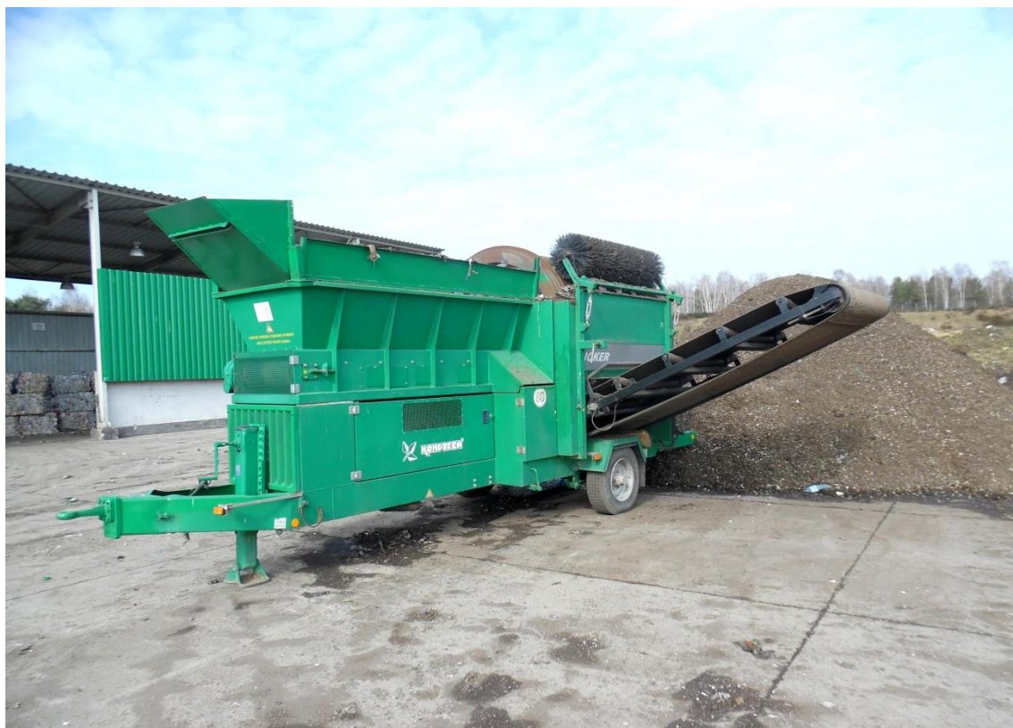
2. Mobilne sito obrotowe do przesiewania odpadów KOMPTECH Joker, nr ser. 31155
