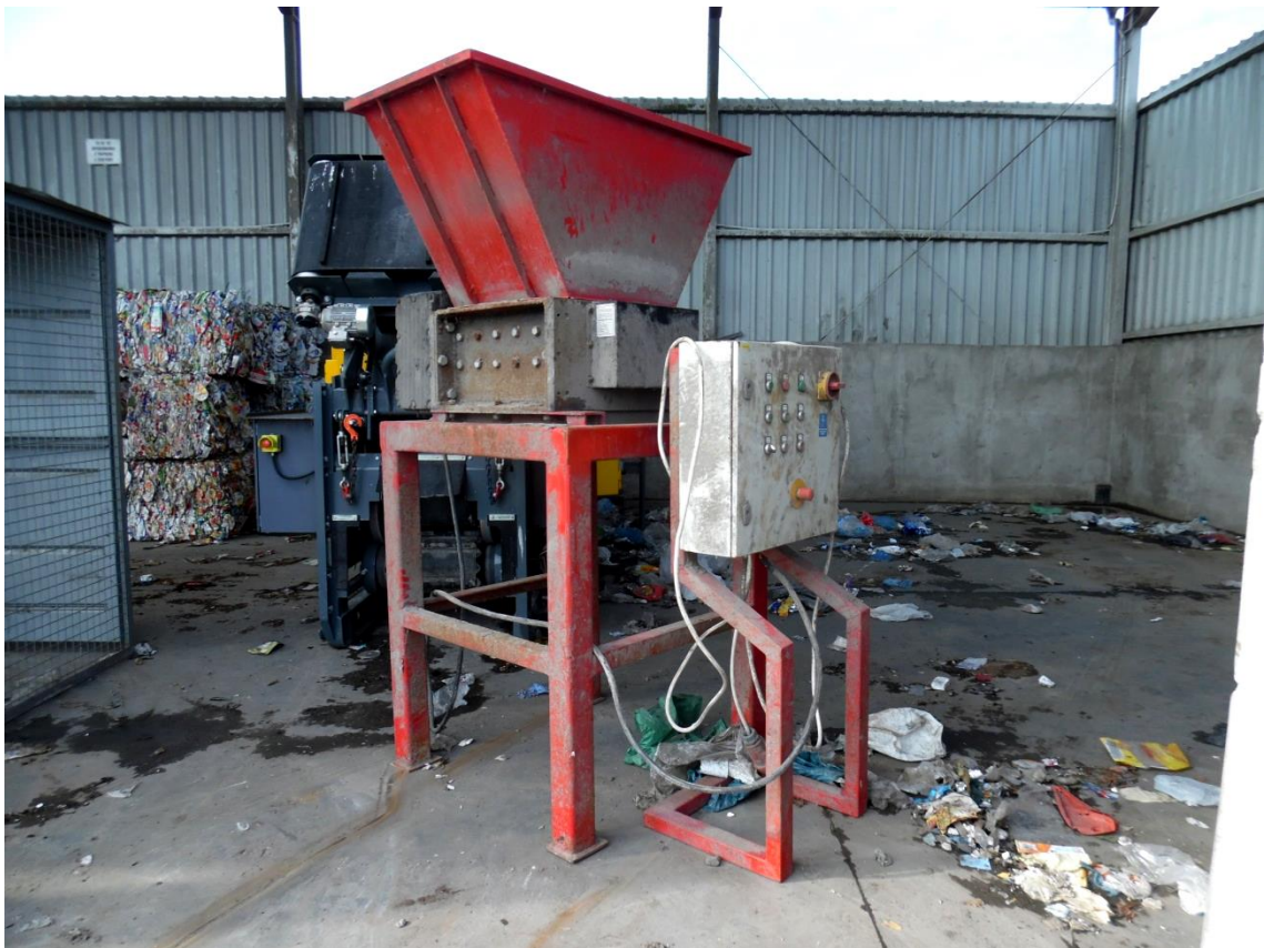
3. Rozdrabniacz odpadów dwuwalowy CASTOR 600, nr ser. 01/2011
