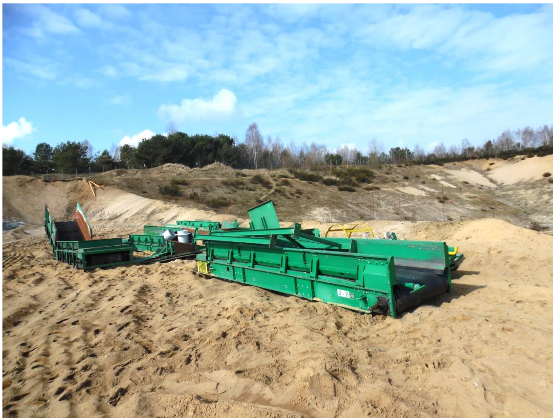
8. Zdemontowane przenośniki taśmowe z linii sortowniczej – 3 szt.
